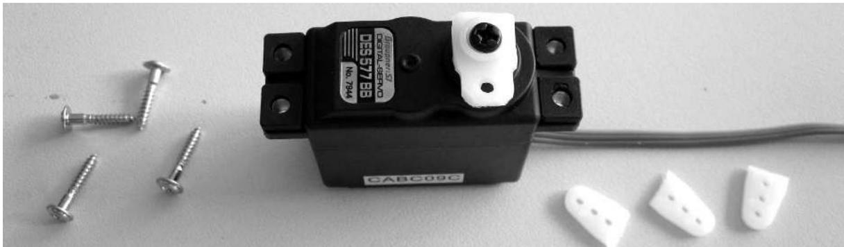
Die Abbildung zeigt das vorbereitete Höhenruderservo, die Hohlknoten von unten in die Gummitüllen einschieben. Die überflüssigen Hebel vom Servosteuerkreuz abtrennen. Das Loch im Servohebel mit  $\varnothing 1,9$  mm aufbohren.
