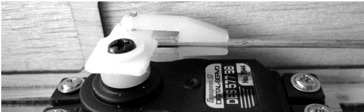
Die Abbildung zeigt das fertig eingehängte Seitenrudergestänge mit Sicherungsclip. Bei Neutralstellung der Ruder und der Servos das Gestänge rechtwinkelig nach oben abbiegen und abtrennen, sodass es noch ca. 1 mm über den Sicherungsclip übersteht.
