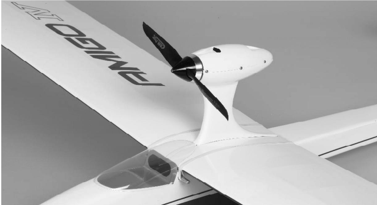
Die Abbildung zeigt die Elektroflug-Version des AMIGO IV mit aufmontiertem Motoraufsatz
