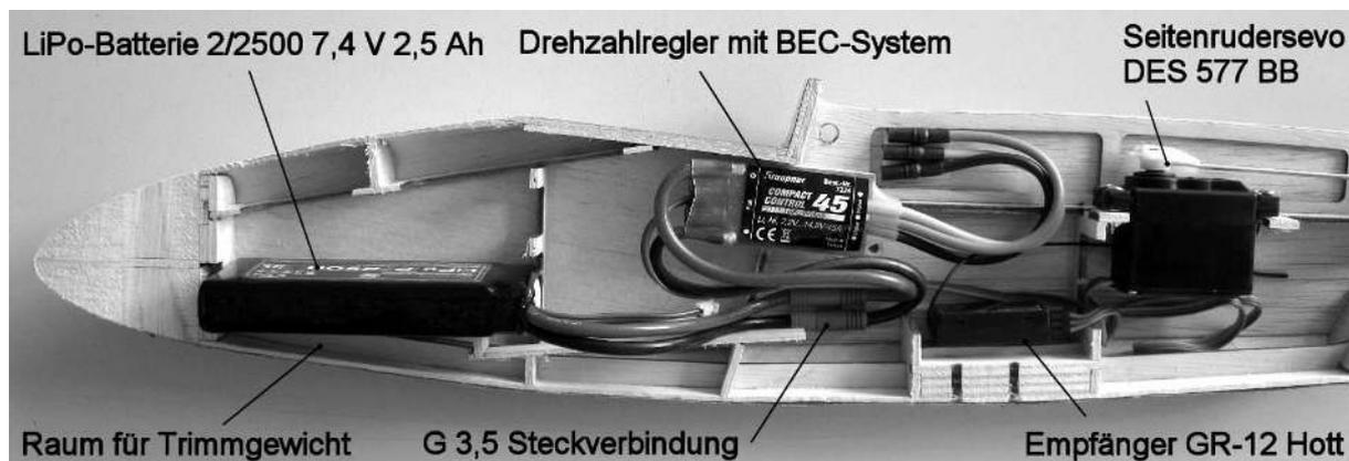
Die Abbildung zeigt die Installation der RC-Komponenten für die Elektroflug-Version. Zur besseren Darstellung ist der Rumpf als Schnittmodell abgebildet.
